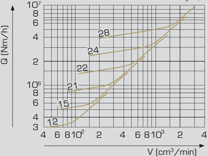
Abführbare Wärmemenge  $Q$  in Abhängigkeit von der Kühllölmenge gültig für durchflutete Kupplungstypen
